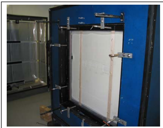
Kuva 3. Koe-elementti asennettuna lämpimän kammion tutkimusaukkoon. Elementin ulkopinta on tutkimusaukkoon päin.
